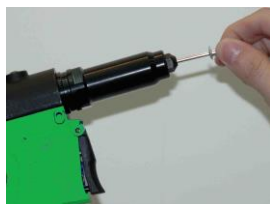
Inserire il rivetto
