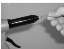
Inserire il rivetto
