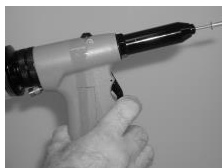
Rimozione dell'olio in eccesso
